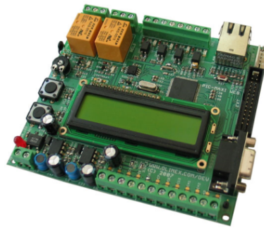
Obrázek 2.2: Vývojový kit Olimex PIC-MAXI-WEB (Zdroj [8])
