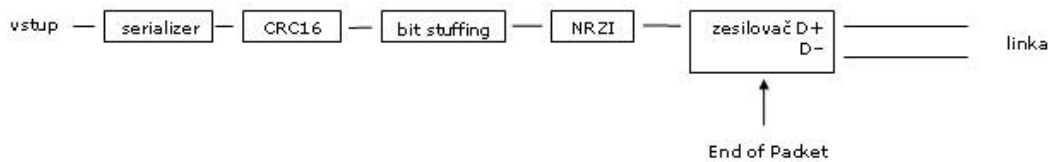
Obrázek 9: Proudové filtry výstupní části řadiče
