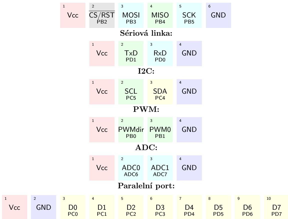
Obrázek 32: Pinout konektorů 4. přípravku
