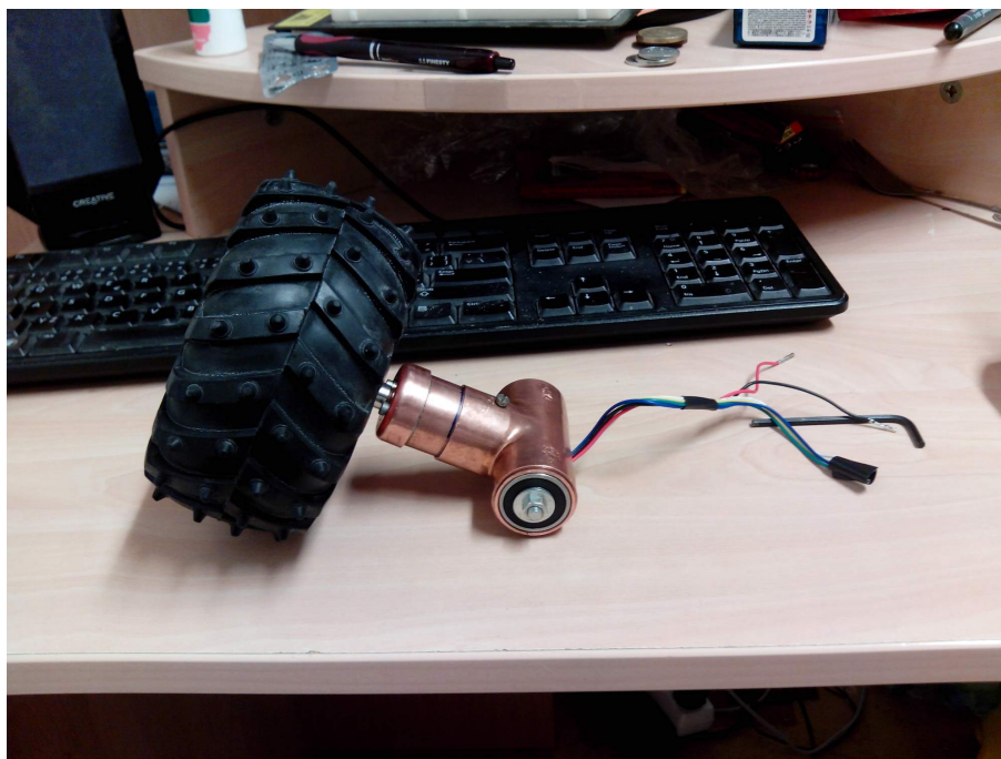
Obrázek 3.3: Smontované kolo včetně měděného T-profilu.
