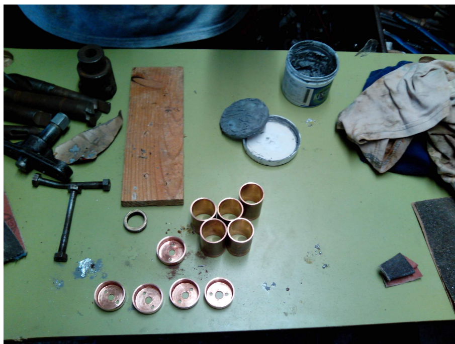
Obrázek 3.2: Příprava pro pájení mědi.
