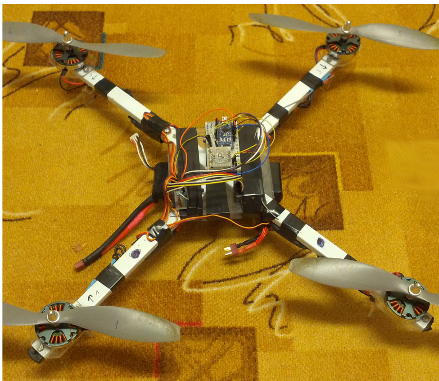
Obrázek 3.1: První verze rámu quadcoptery s deskou Arduino Nano.
