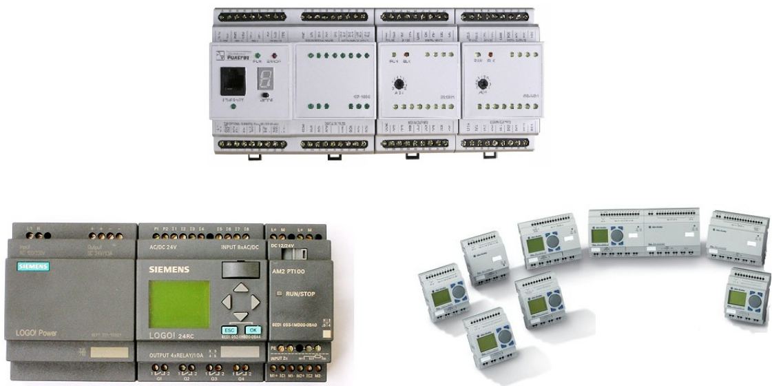
Obrázek 3.1: Automaty firem TECOMAT nahoře, SIEMENS vlevo a Allen Bradley vpravo
