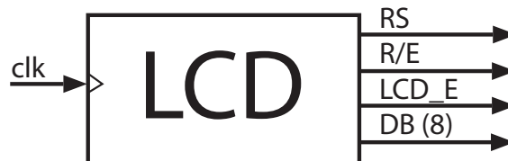
Obrázek 3.4: Blokové schéma VHDL návrhu aplikace pro obsluhu LCD displeje
